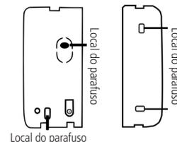
**Importante:** verifique se a distância do GAP (distância entre o sensor e o ímã) está dentro do especificado, para evitar disparo indesejado caso ocorra alguma vibração na estrutura em que o sensor está instalado.
